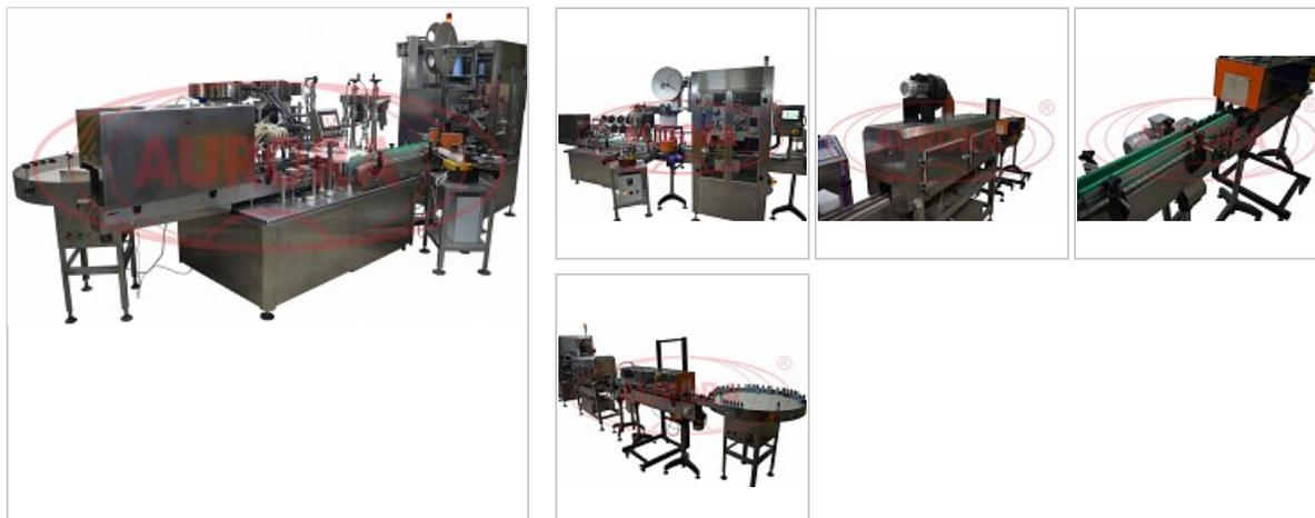
Моноблок предназначен для дозированной подачи продукта во флаконы с последующей их укупоркой и этикетированием с нанесением даты на упаковку.
